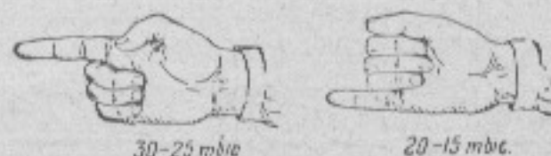
Рис. 42. Определение возможности ведения огня поверх своих подразделений с помощью пальцев руки, вытянутой на 50 см
