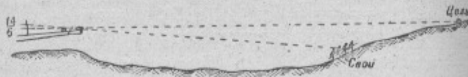
Рис. 40. Определение возможности ведения огня поверх своих подразделений отметкой по прицелу
