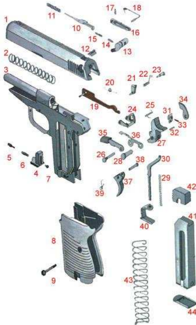
Rys. 6. Przekrój pistoletu P-83 – poszczególne elementy
