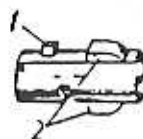
Rys. 16. Tłok zaporowy: 1 — czop; 2 — rygle
