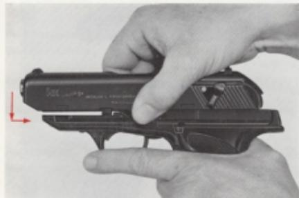
Bild 13: Verschlussstück aufsetzen
