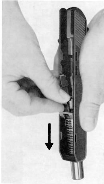
Fig. 9: Forma de desmontar la corredera Fig. 9: Dépose du bloc-culasse
