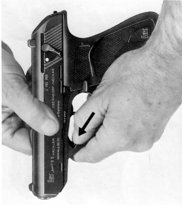
Fig. 9: Forma de desmontar la corredera Fig. 9: Dépose du bloc-culasse
