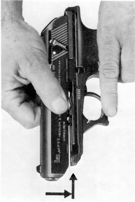
Fig. 13: Forma de montar la corredera Fig. 13: Montage du bloc-culasse
