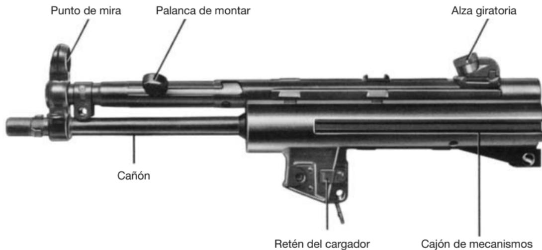
Fig. 4 Cajón de mecanismos con cañón y dispositivos de montar y de puntería
