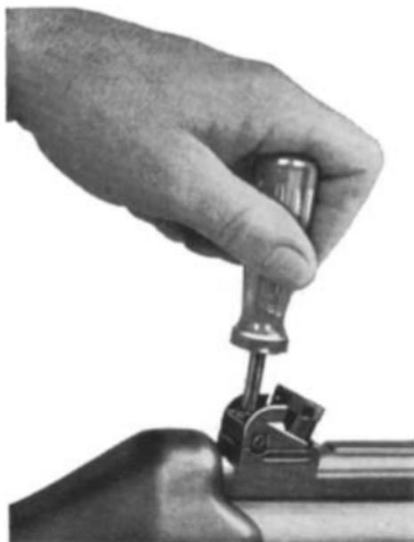
Fig. 39 Aflojar tornillo de apriete
