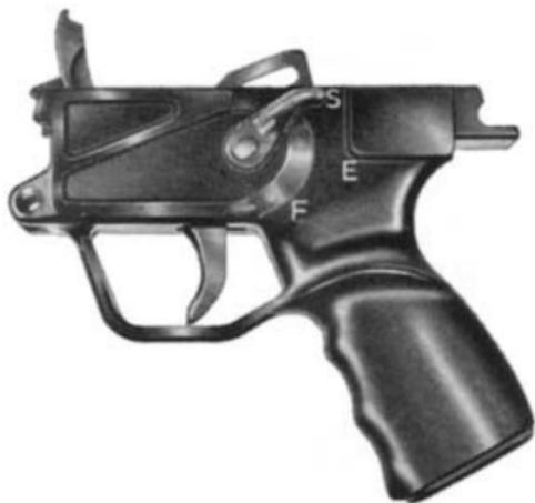
Fig. 12 Empuñadura con dispositivo de disparo
