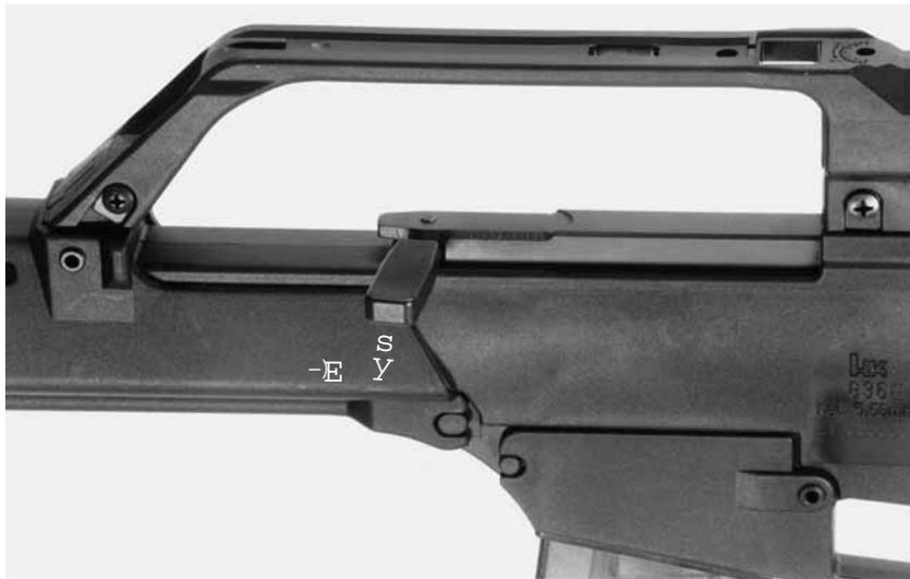
Figura 27 Empujar hacia dentro la palanca de montar (apoyo del cierre)
