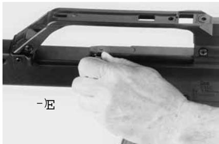
Figura 24 Girar hacia fuera la palanca de montar y desplazarla hacia atrás
