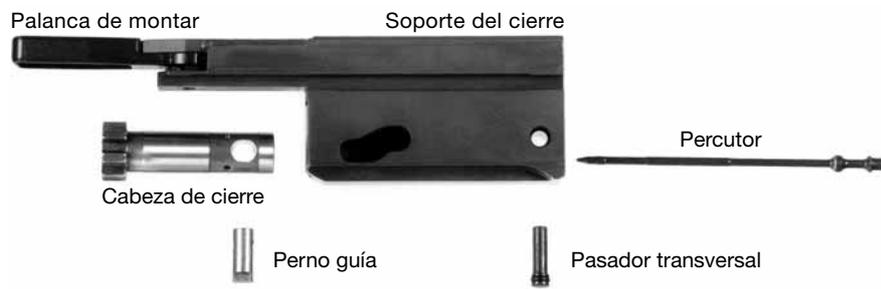
Figura 32 Desmontaje del cierre
