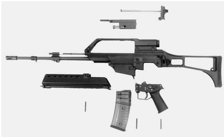
Figura 36 Desmontaje del G36 E en sus grupos componentes
