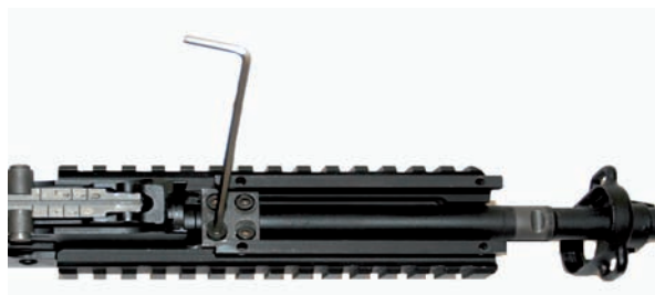
Rys. 77. Demontaż zintegrowanego zespołu łoża z nakładką z szynami – odkręcanie wkrętów
