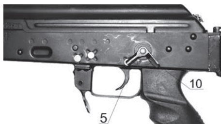
Rys. 102. Położenie przełącznika rodzaju ognia w pozycji C (ogień ciągły)
