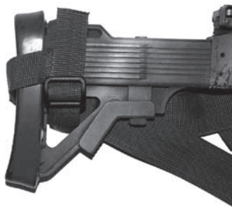
d/ Zakładanie koszyka na trzewik kolby e/ Mocowanie koszyka na trzewiku kolby Rys. 40. Pas taktyczny 3-punktowy – montaż pasa do karabinu (kolejne etapy)
