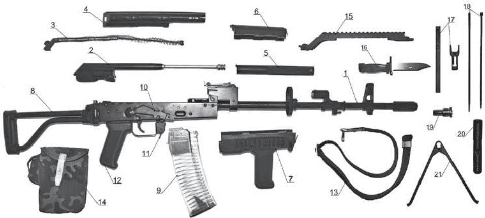
Rys. 2. a - Widok ogólny 5,56 mm karabinu szturmowego – wariant B; b - Zasadnicze części i zespoły karabinu: 1- komora zamkowa z lufą; 2-suwadło z zamkiem; 3-urządzenie powrotne; 4-pokrywa komory zamkowej; 5-rura gazowa; 6-nakładka; 7-zsp. łoża z chwytem i dwoma szynami bocznymi; 8-kolba z osadą; 9-magazynek przezroczysty 30-nb; 10-bezpiecznik; 11-zatrzask magazynka; 12-rękojeść; 13-pas do broni strzeleckiej; 14-torba na magazynki; 15-zsp. szyny celowniczej szybkoodłączalnej; 16-bagnet, 17- łódka z nasadką; 18-wycior; 19-odrzutnik do ślepego strzelania; 20-przybornik z przyborami 21-dwójnóg.
