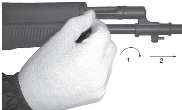
Rys. 74. Odłączanie łoża, nakładki i rury gazowej
