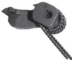
Rys. 88. Sposób złożenia kurka ze sprężyną i urządzeniem zapadkowym
