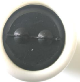
Rys. 43. Dwa nadlewy na czole pocisku gumowego CHR-B-30
