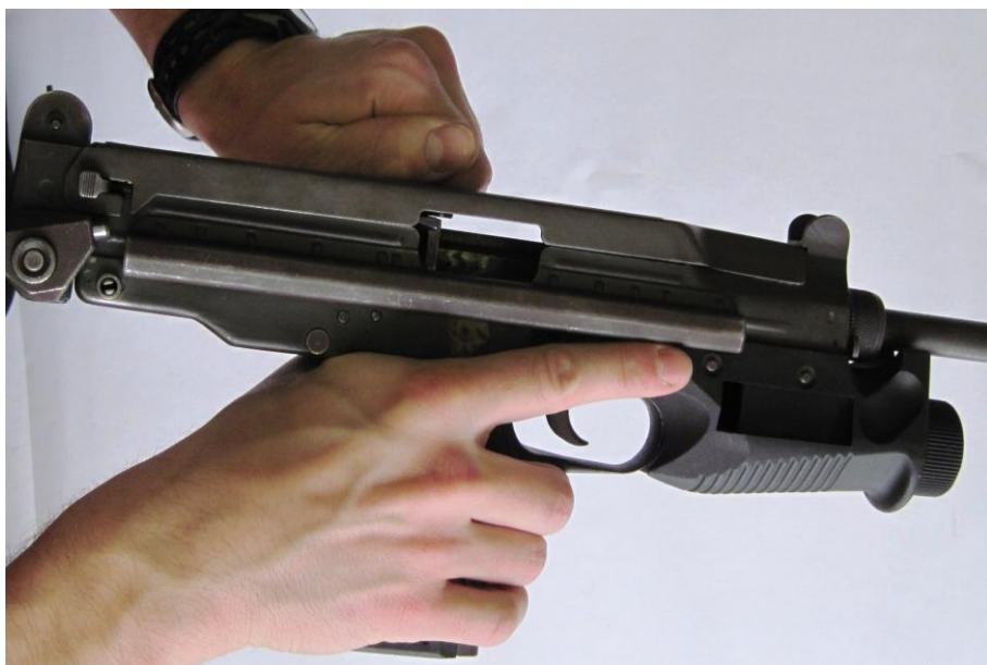
Rys. 10. Sprawdzenie broni przed przystąpieniem do jej rozłożenia
