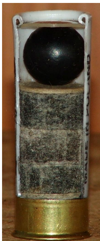
Rys. 45. Przekrój amunicji niepenetracyjnej. Filcowa przybitka (sabot) oddziela gumowy pocisk od ładunku prochowego znajdującego się w dolnej części naboju
