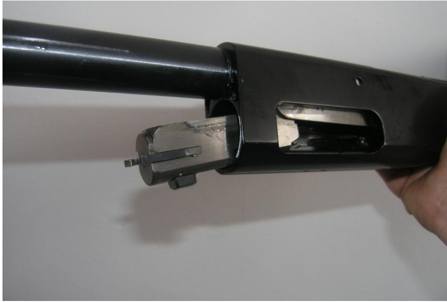
Rys. 33. Wyciągnięcie zamka przez okno osadzenia lufy
