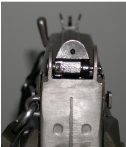
Rys. 8. Przyrządy celownicze szczerbinkowe
