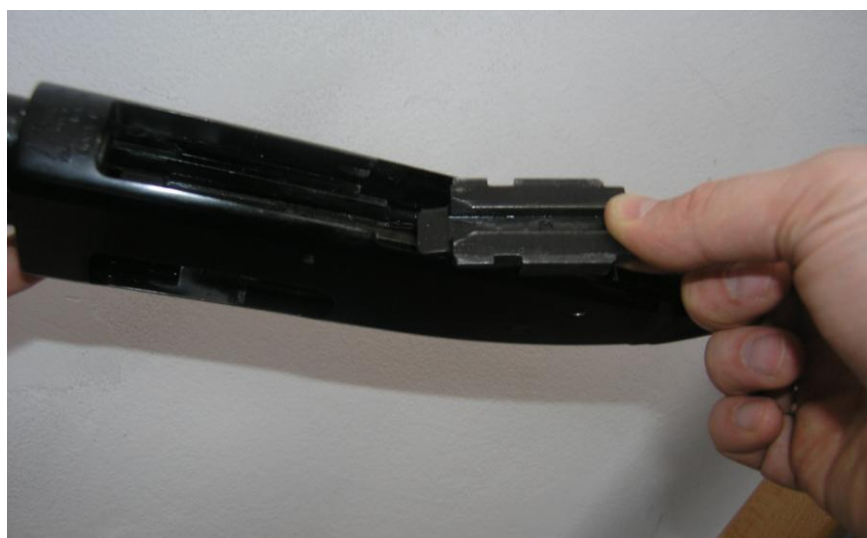
Rys. 31. Wyjęcie ramki suwadła
