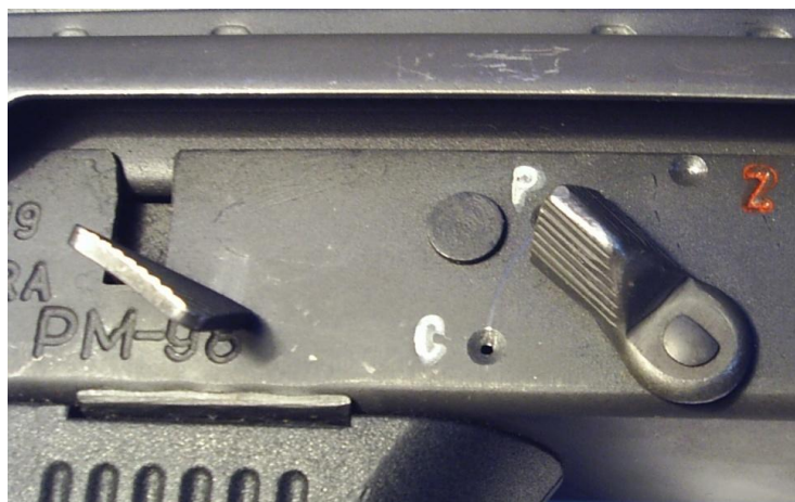
Rys. 4. Bezpiecznik – przełącznik rodzaju ognia pistoletu maszynowego PM-98
