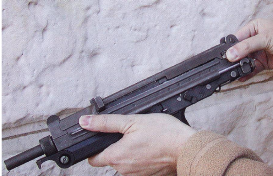
Rys. 11. Zwolnienie zatrzasku pokrywy komory zamkowej
