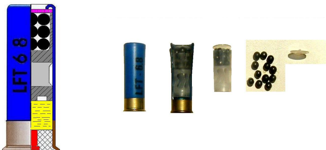
Rys. 49. Przekrój amunicji penetracyjnej LFT 6,8
