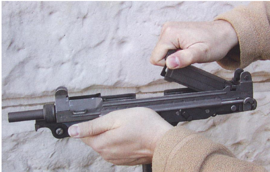
Rys. 14. Wyjęcie zespołu zamka
