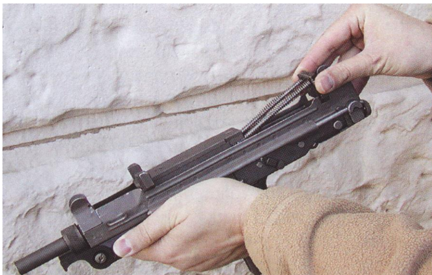
Rys. 13. Odłączenie urządzenia powrotnego
