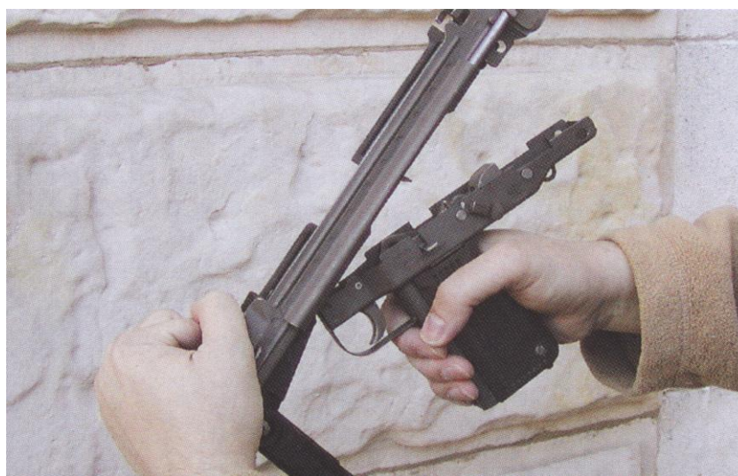
Rys. 19. Odłączenie zespołu chwytu od zespołu komory zamkowej
