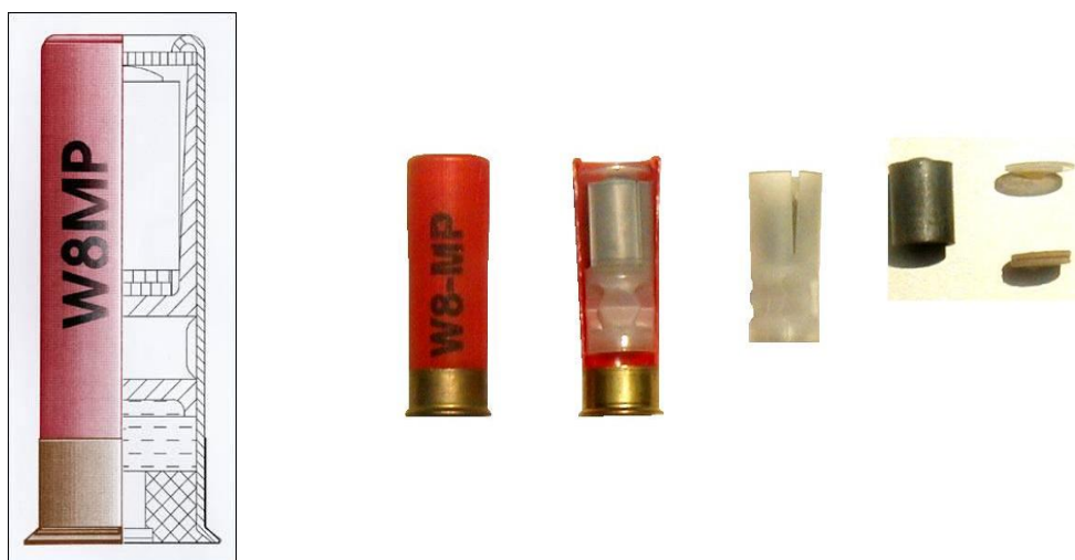
Rys. 47. Przekrój amunicji penetracyjnej W 8 MP
