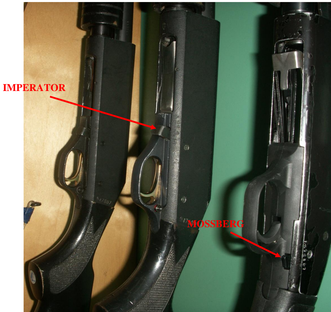
Rys. 26. Różnica w umiejscowieniu zatrzasku suwadła w strzelbie IMPERATOR i MOSSBERG
