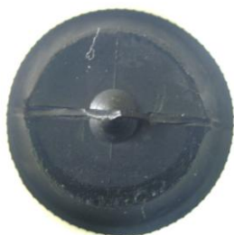
Rys. 42. Jeden nadlew na czole pocisku gumowego CHR-B-20
