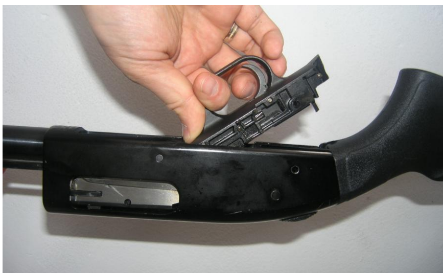
Rys. 29. Wyjęcie mechanizmu spustowo-uderzeniowego
