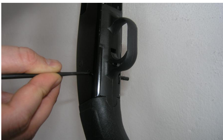
Rys. 28. W celu odłączenia mechanizmu spustowo-uderzeniowego należy wybić sworzeń łączący mechanizm z zespołem komory zamkowej i kolby
