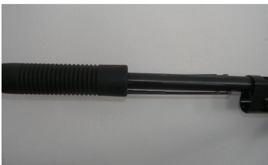
Rys. 32. Odłączenie rękojeści przeladowania z listwami
