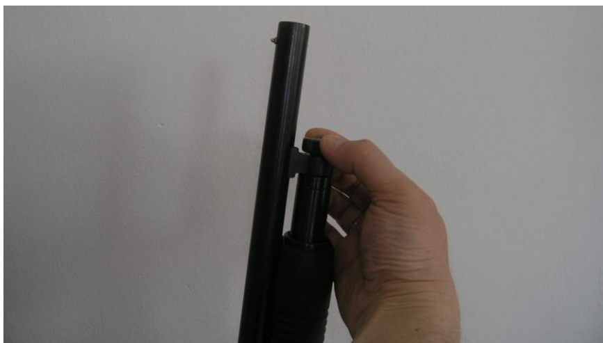
Rys. 27. Należy umieścić zespół przesuwny w położeniu pośrednim, co ułatwia późniejsze wyjęcie zespołu lufy, odkręcić śrubę przy łączniku rury magazynka i wyjąć lufę
