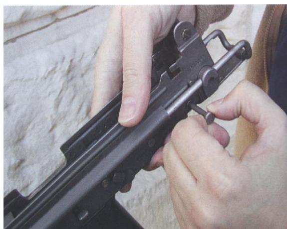
Rys. 18. Odłączenie tulei łącznika
