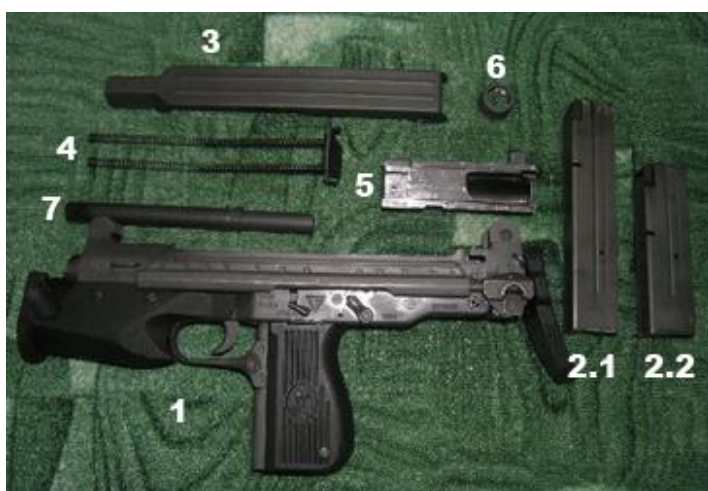
Rys. 5. Pistolet maszynowy PM-98 częściowo rozłożony
