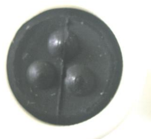
Rys. 44. Trzy nadlewy na czole pocisku gumowego CHR-B-50
