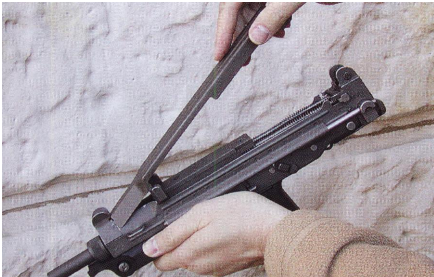
Rys. 12. Odłączenie pokrywy komory zamkowej
