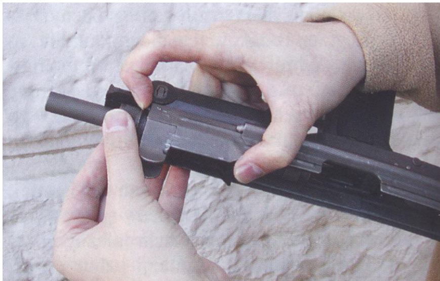
Rys. 15. Odkręcenie nakrętki mocującej lufę – należy wcisnąć zatrzask nakrętki mocującej lufę i ją odkręcić
